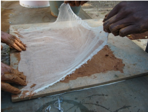
Figura 20. Aplicação de manta de gase industrial em algodão cru sobre compósito de fibroso para aumento de resistência às tensões superficiais da peça
