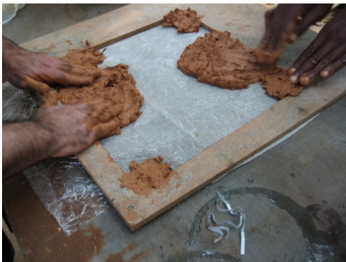
Figura 18. Aplicação inicial do composto de fibrosolo na forma de madeira compensada.
