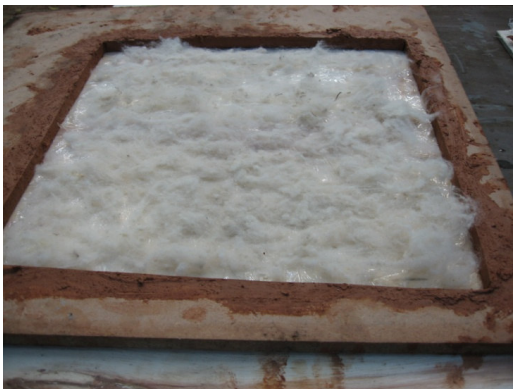
Figura 25. Preparo de uma cama em lã natural como base para receber o compósito de fibrosolo leve.
