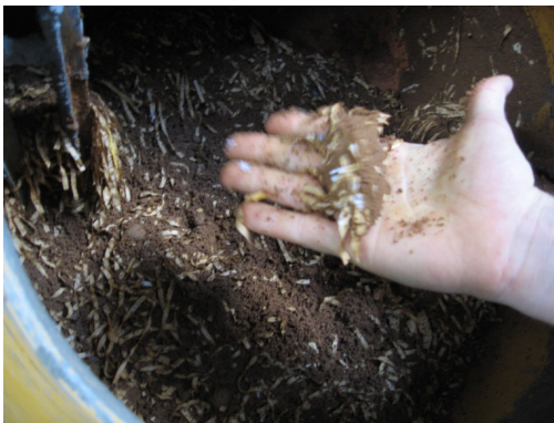
Figura 38. Aferição da capacidade umidade do compósito para ideal plástico na confecção das placas leves vibradas.
