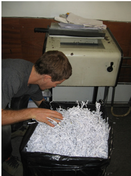
Figura 30. Produção de fitas finas de papel descartado para mistura em compósito de fibrosolo.
