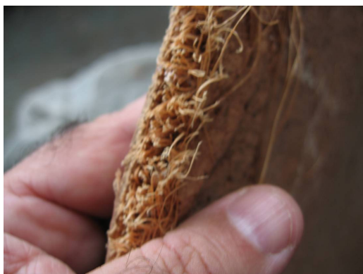
Figuras 12 e 13. Amostras de placa de fibroso mostrando a grande quantidade de fibras agregadas ao solo
