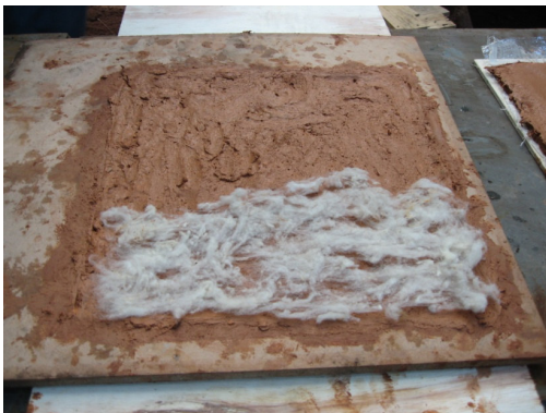
Figura 28. Após moldada a placa de fibrosolo na forma de madeira compensada, aplica-se nova camada de lã natural.
