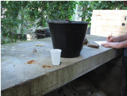
Figura 35. Anotações e equipamentos utilizados para experimento. A adição de água se deu na proporção de 600ml para cada balde de terra.
