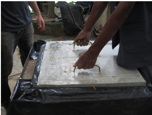
Figura 42. Lastro de compressão aplicado sobre compósito para receber vibração do equipamento.
