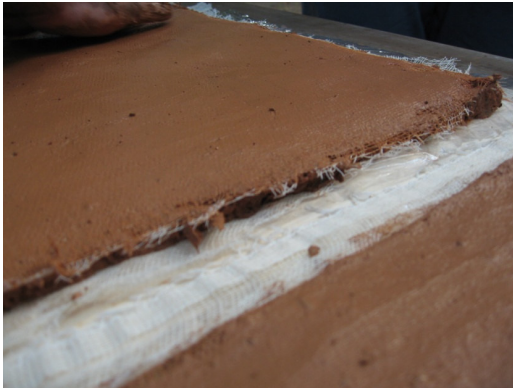
Figura 24. Detalhe das placas em fibrosolo leve.
