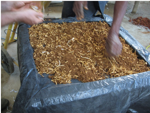
Figura 41. Aplicação de material compósito na forma sem receber revestimentos de proteção superficial.
