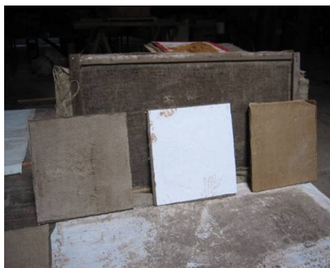
Figuras 14 e 15. Desenvolvimento de placas de fibroso para aplicação em painéis de fechamento de construções, reaproveitando e aprimorando conhecimentos tradicionais.
