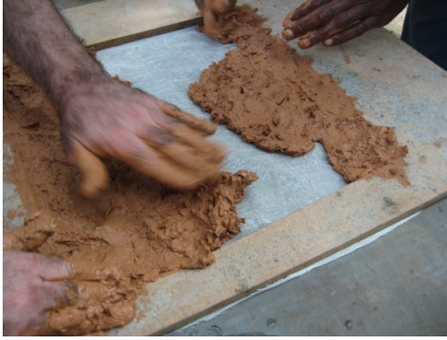
Figura 19. Aplicação e distribuição homogênea do compósito de fibroso na forma de madeira compensada.
