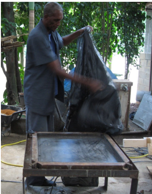
Figura 39. Preparo da forma forrada com lona plástica para receber e posteriormente retirar a placa de fibrosolo.
