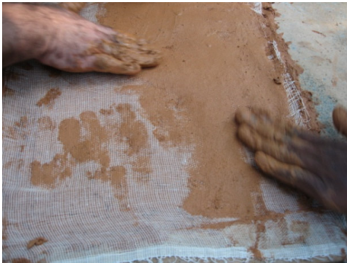
Figura 21. Procedimentos gestuais técnicos para envolvimento e fusão da gase industrial com o compósito.
