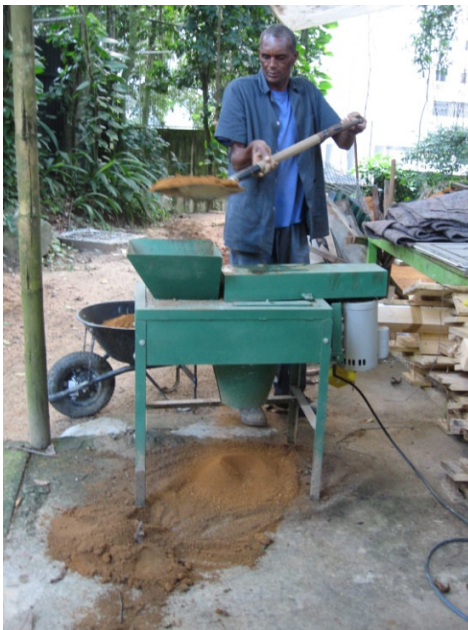
Figura 33. Preparo da terra a ser usada no compósito. Destorroamento mecânico em laboratório.
