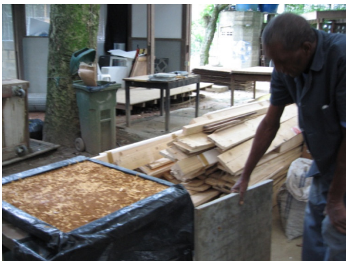
Figura 43. Peça finalizada e compactada após processo vibratório, para posterior disposição em secagem a sombra.
