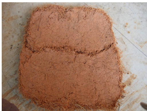
Figuras 12 e 13. Amostras de placa de fibroso mostrando a grande quantidade de fibras agregadas ao solo
