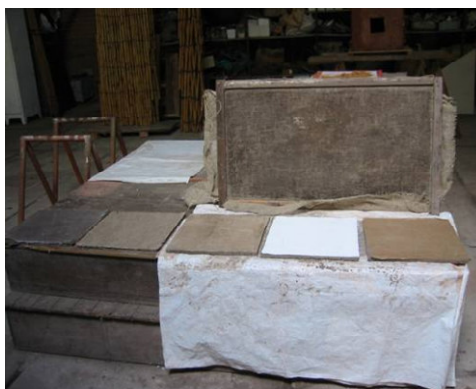
Figuras 14 e 15. Desenvolvimento de placas de fibroso para aplicação em painéis de fechamento de construções, reaproveitando e aprimorando conhecimentos tradicionais.
