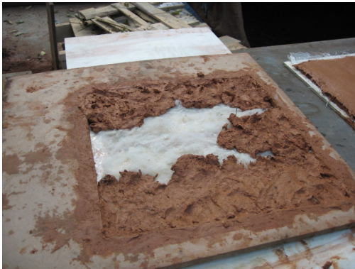
Figura 26 e 27. Aplicação da massa de compósito de fibrosolo com fitas de jornal sobre cama de lã natural
